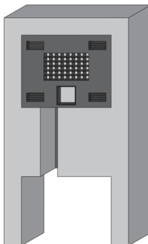
A mureta deverá ser pré-moldada, conforme o padrão da concessionária. Após instalado, deverá ser solicitado à concessionária para execução da ligação de água.
