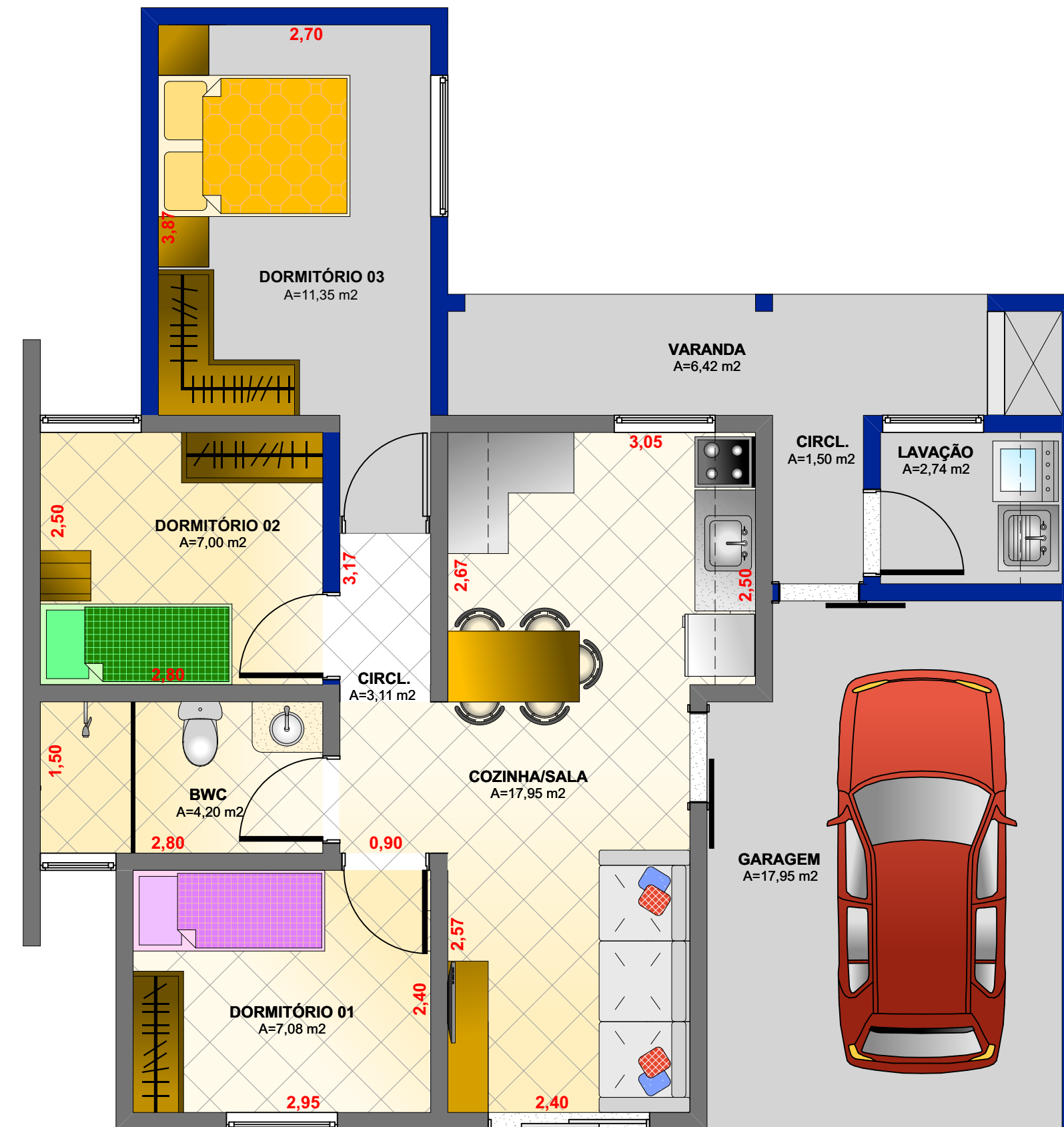
PLANTA BAIXA HUMANIZADA - SUGESTÃO DE AMPLIAÇÃO ÁREA DE AMPLIAÇÃO: 44,07 m 2 ÁREA TOTAL: 91,81 m 2 ESC.: 1/50
