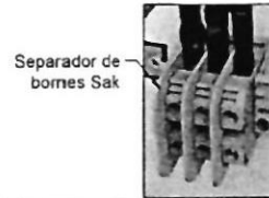
Detalhamento de separação dos bornes sak para cabos até 10mm² ESC.: S/E
