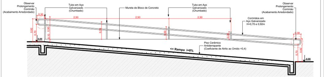
**DETALHE 06 - GUARDA-CORPO EM AÇO GALVANIZADO**
