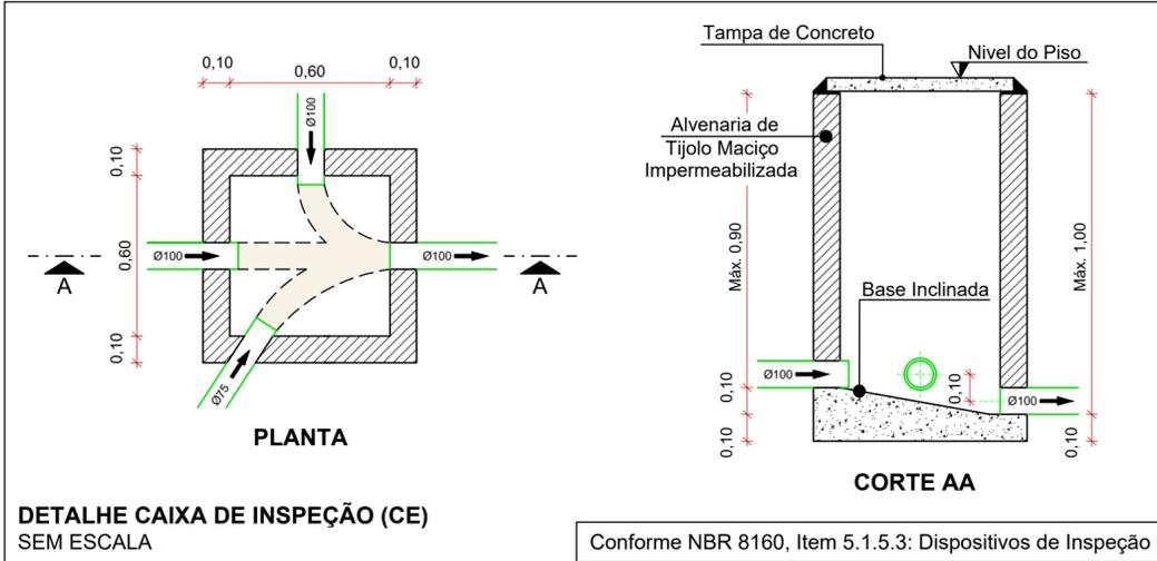
**DETALHE CAIXA DE INSPEÇÃO (CE)**
