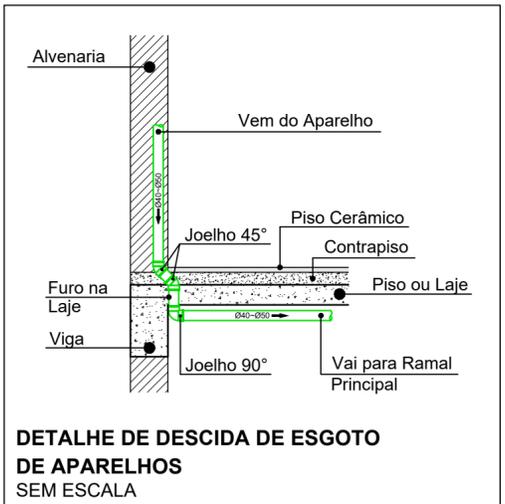
**DETALHE DE DESCIDA DE ESGOTO DE APARELHOS**
